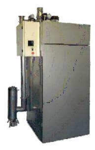
Термокамеры КОН-5 X/К предназначены для производства вареных и копченых изделий из мяса и рыбы. Термокамера КОН-5 X/К позволят выполнять следующие технологические операции:
