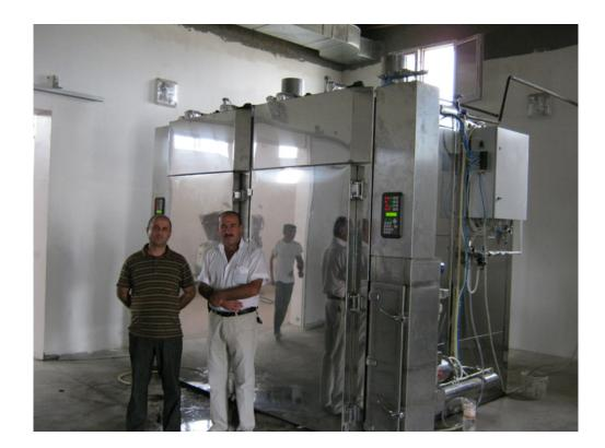
Термокамеры обработки нагревом КОН100 предназначены для использования в цехах мясной, рыбной и птицеперерабатывающей промышленности для подсушки, обжарки, варки и копчения вареных, варено-копченых, полукопченых колбас, соси¬сок, сарделек, свинокопченостей, птицы и рыбных изделий.
